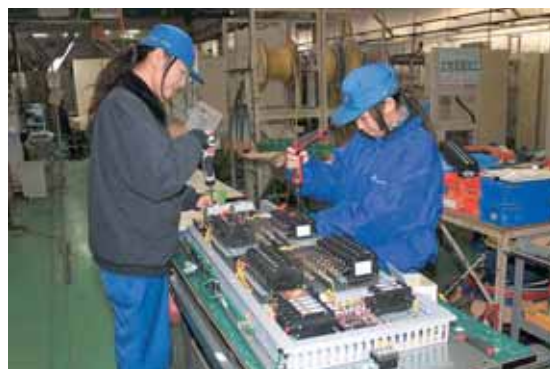
制御盤・分電盤の組立配線作業をする岡本さんと大槻さん
