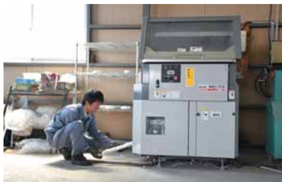
発砲スチロールを熱で溶かして固める「減容作業」をする富樫さん
