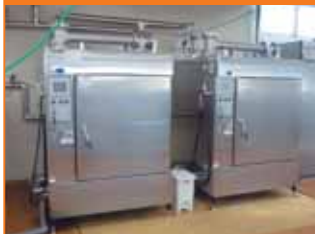
サラダなどの冷温調理の温度保持のための真空冷却機2基設置
