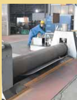
ベンディングロールでステンレス鋼板の加工を行う小野さん
